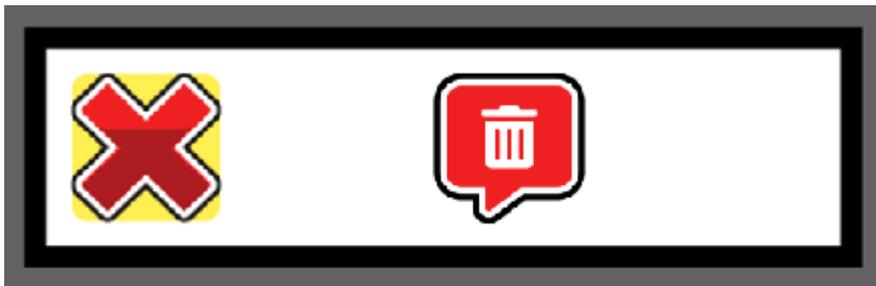
Die Schaltfläche Abbrechen (das große rote Kreuz) beendet den Löschvorgang, wohingegen die andere Schaltfläche Kommentar löschen, den Löschvorgang bestätigt und den Kommentar aus dem Dokument löscht.
